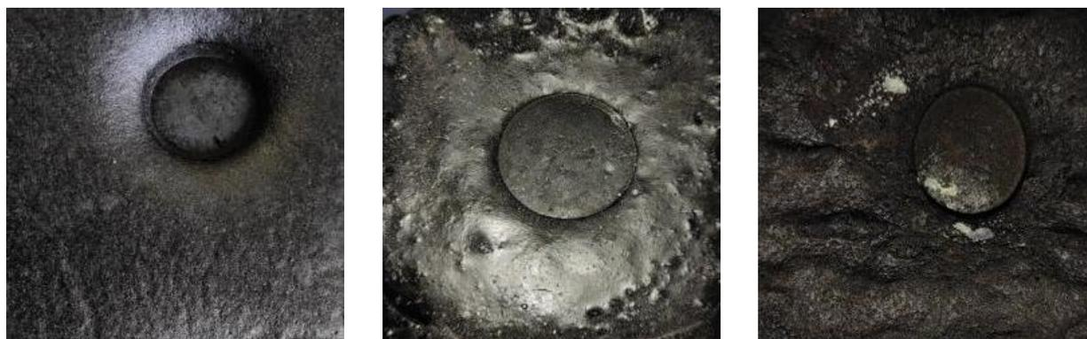
Figure 3. Morphologie des asphaltes immergés dans différente solutions.
