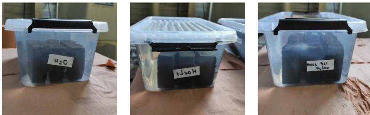
Figure 4. Echantillons d'asphaltes coulés immergés dans les différentes solutions chimiques.
