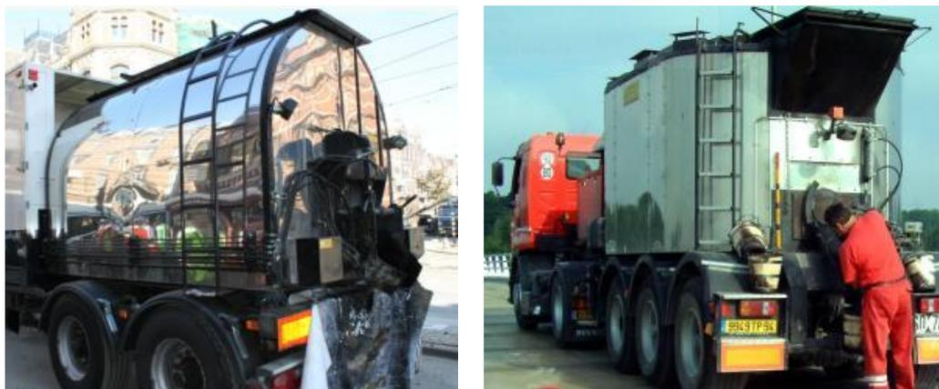
Figure 9. Malaxeur à axe vertical (à droite) - Malaxeurs à axe horizontal (à gauche).
