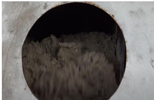
Figure 6. Opération de traitement des sédiments dans un malaxeur
